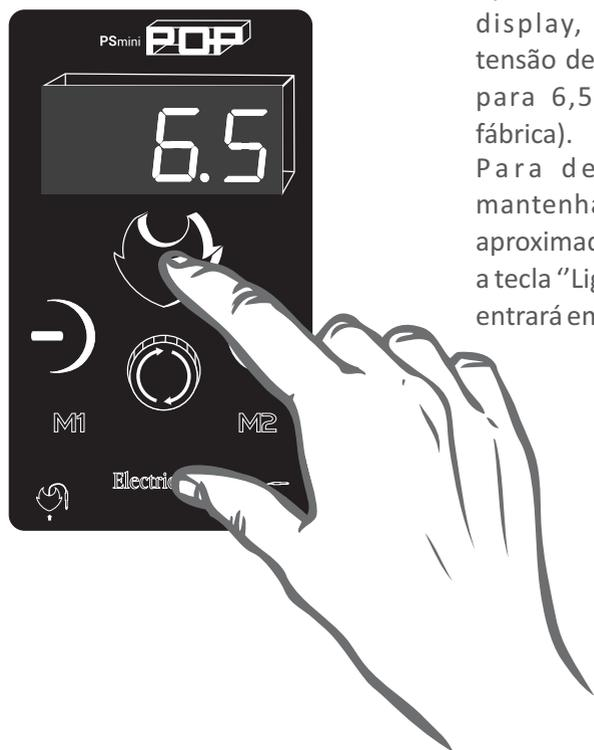
Observação: No primeiro uso aparecerá o valor 6,5 no display, indicando que a tensão de saída está ajustada para 6,5 Volts (ajuste de fábrica).
